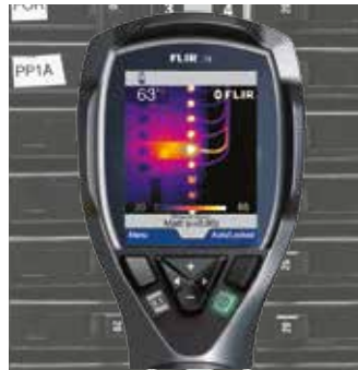
FLIR i3, temperatura en 3.600 puntos
